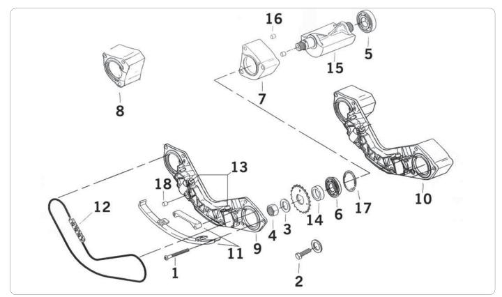
**ENGINE BALANCER PARTS FOR TWIN CAM B MODELS**
