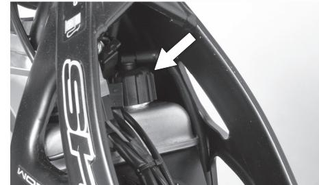
Para acceder a la boca de llenado del radiador del sistema de refrigeración debe quitarse primero el depósito de combustible. Es aconsejable realizar esta operación siempre con el motor en frío.
