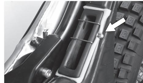
Si la moto se utiliza en terreno muy polvoriento, es aconsejable limpiar con asiduidad el filtro de aire con agua y detergente. Una vez secado debe engrasarse con aceite indicado para elementos filtrantes y comprobar que se ha colocado correctamente.
