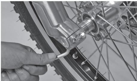
Para el vaciado de aceite de la suspensión debe realizarse aflojando con una llave Allen nº 8 el tornillo que se encuentra en la parte inferior de la botella. Una vez aflojado, presionar la suspensión varias veces para el completo vaciado de aceite. Es muy importante que al poner de nuevo el aceite se ponga la viscosidad y la cantidad adecuada como explica la tabla de reglajes.
