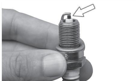
El estado de la bujía nos permitirá conocer si el motor realiza una correcta combustión. Es por ello que este elemento debe estar siempre en perfectas condiciones y con la separación entre el electrodo y el arco según las recomendaciones del fabricante.
