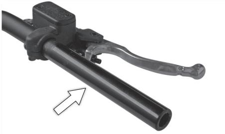
Es importante mantener el manillar limpio y engrasado en el punto donde va anclado el puño del gas. De no ser así, puede ocurrirse un accionamiento irregular a causa de roces.
