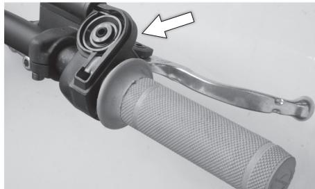
La maneta del freno delantero debe ajustar a la medida en que pueda ser accionada con facilidad y ejercer sobre ella la presión adecuada para frenar correctamente. Antes de ejercer presión sobre el pistón debe tener un recorrido libre mínimo de 15mm. Al mismo tiempo limpiar y engrasar el interior del puño.
