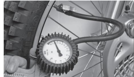
Dependiendo del tipo de terreno, la presión de los neumáticos puede variar según las necesidades. Los neumáticos son de tipo tubeless y al no llevar cámara pueden trabajar a presiones muy bajas, aunque no se recomienda una presión inferior a 0,35 kg.
