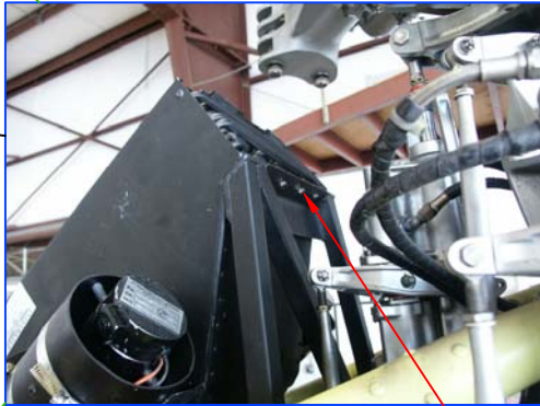
D-D AN3-4A BOLTS AN960-10 WASHERS 4 EA.
