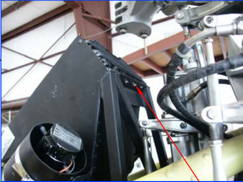
D-D AN3-4A BOLTS AN960-10 WASHERS 4 EA.
