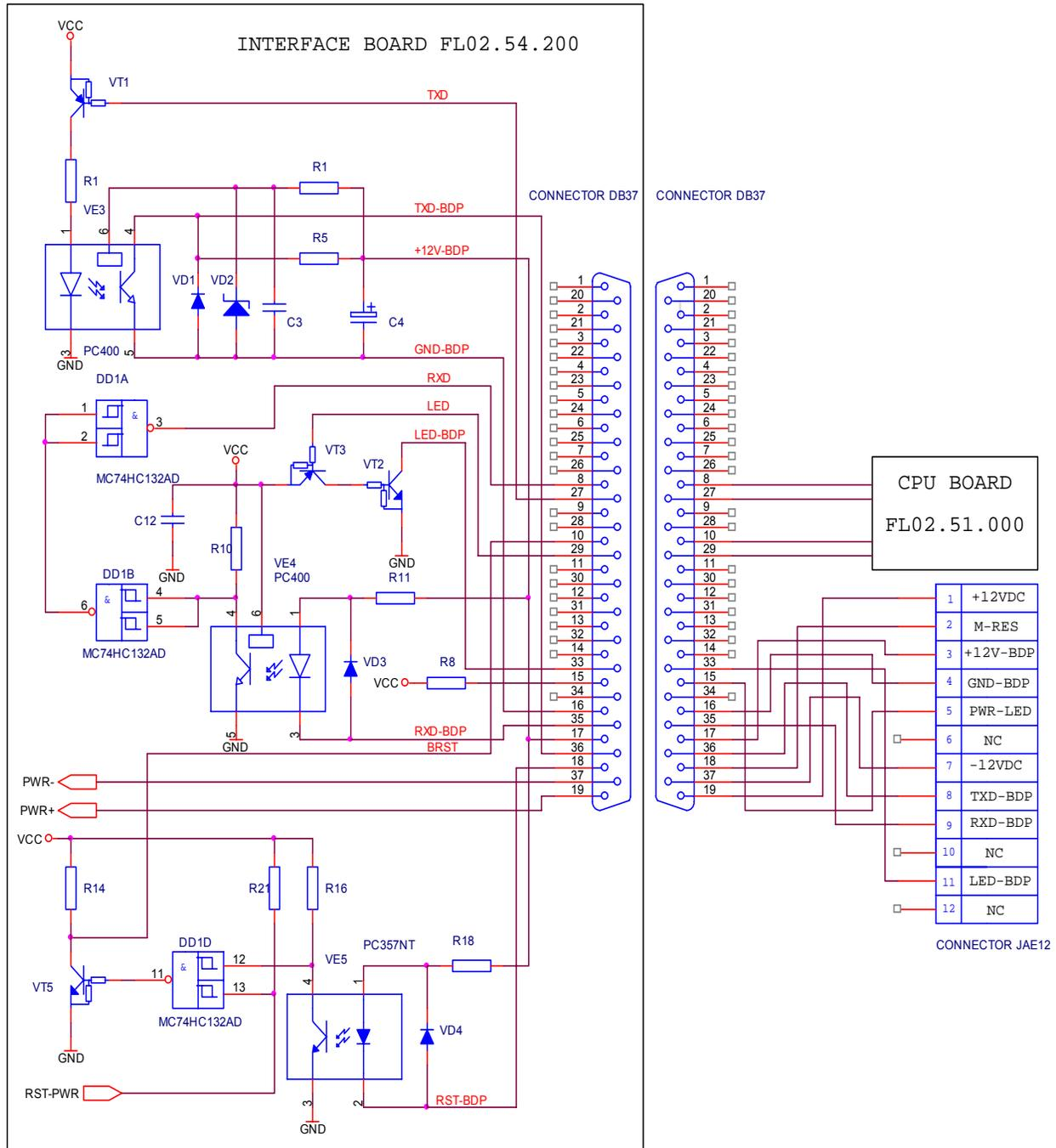
**INPUT/OUTPUT CIRCUITS RS-232 VERSION 12V**
