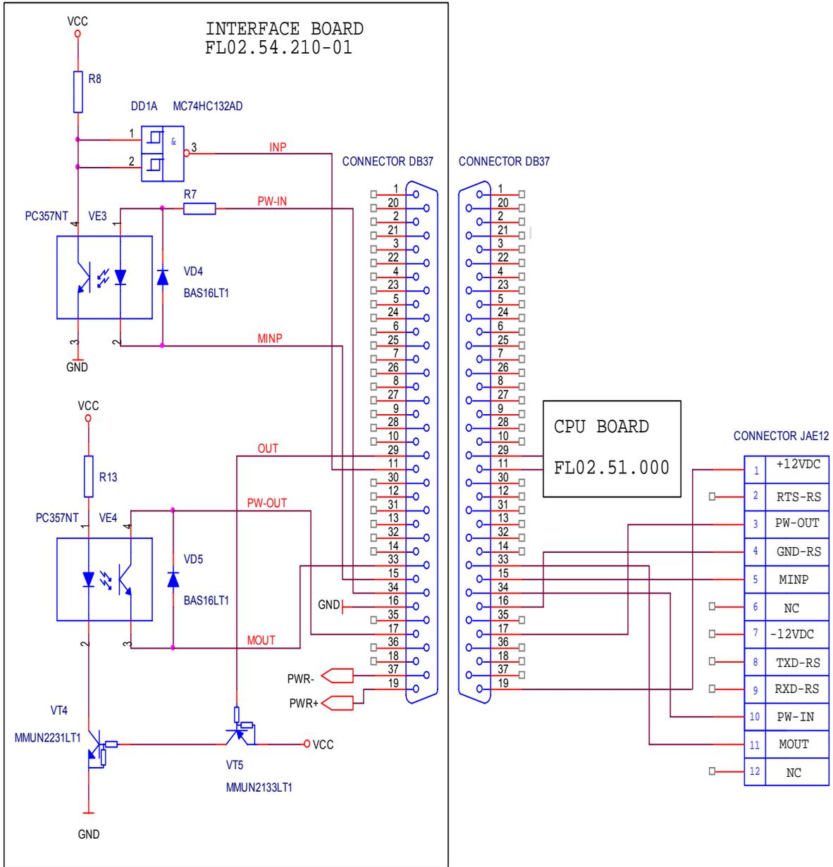
**INPUT/OUTPUT CIRCUITS RS-232 VERSION 24V**
