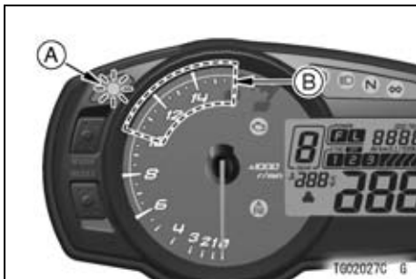
A. Yellow Shift Up Indicator Light B. Adjustable Range
