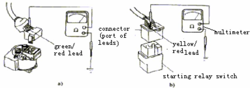
INSPECTION FOR GROUNDED CIRCUIT OF STARTING RELAY
