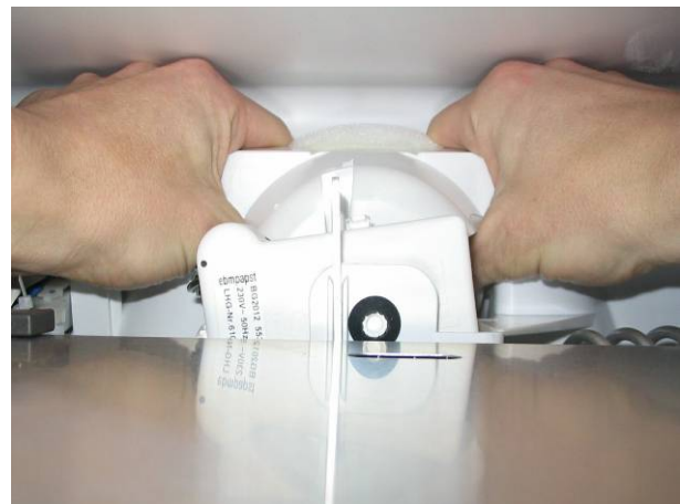
Fig. 5.3.11/ 2 Dismantling fan blade
