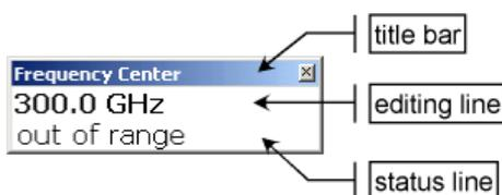
**Fig. 5-2: Edit dialog box for parameter entry**
