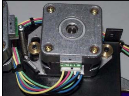
Fig. 28. Color wheel 1 motor
