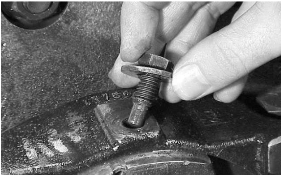
Remove lock bolt.
