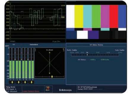
► AV Delay Measurement.
