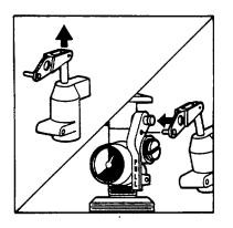
12. Secure fill cap, hand tighten.
