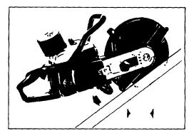
Vid kapning i sten betong eller liknande material bor skivan foras fram och tillbaka i spåret så att man får god varmeavledning och låg temperatur i slippunkten. Finns det mojlighet att kyla skivan med vatten uppnås mycket god skivekonomi
