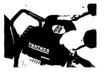
Forfiltret skall dragas av och skakas rent vid varje tankning Det skall tvattas ordentligt eller bytas efter ca 30 kortimmar i stälmaterial och efter ca 20 kortimmar i betong eller liknande material som framkallar kraftig dammbildning
