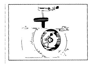
Gor fast andra anden vid linskivan Lagg på några varv av linan och montera linskivan Spann startfjadern genom att med linan i urtaget vrida linskivan medurs ett eller två varv Dra i startlinan så att starten griper in i svanghjulet, innan flaktkåpan skruvas fast på maskinen
