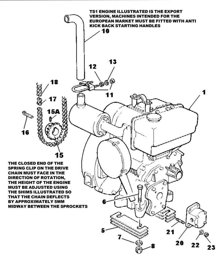
SEAL THE HYDRAULIC PUMP TO THE ENGINE USING A GOOD QUALITY JOINTING COMPOUND
