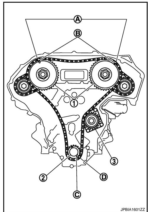
5. Install internal chain guide (1), slack guide (2).
