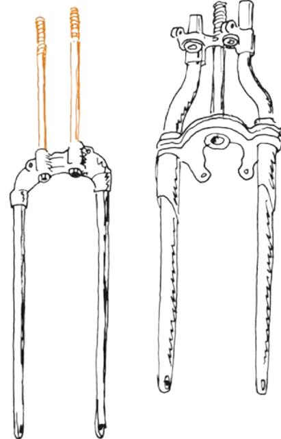
Ponga una tuerca de 7/16"-20 en la varilla de cada amortiguador, empuje el resorte inferior e introduzca cada varilla en su orificio respectivo de la horquilla. Las varillas deben sobresalir de la horquilla la misma longitud.
