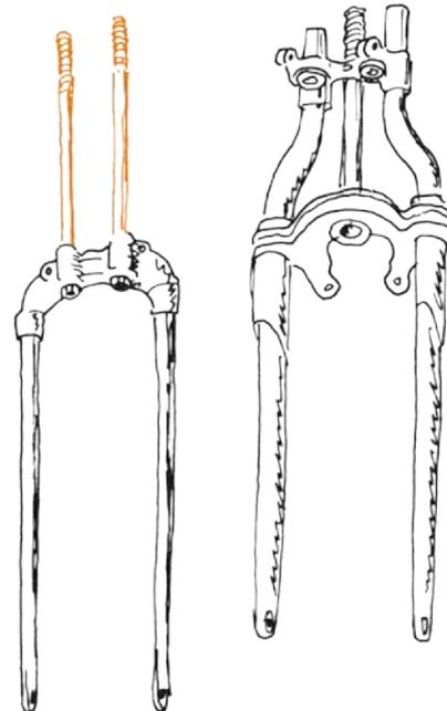
Avvitare un dado da 7/16"-20 su ogni sospensione, posizionare la molla inferiore e infilare ogni sospensione dentro il suo foro nella forcella delle molle. Gli ammortizzatori devono sporgere in basso a destra e a sinistra per la stessa lunghezza.
