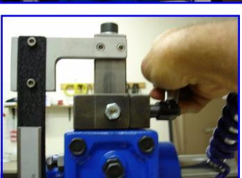
NOW PLACE A GAGE BLOCK UNDER THE LEFT HAND SIDE OF THE DEAD STOP THAT IS EQUAL TO THE FULL LIST TO GET YOUR "INSTALLED HEIGHT"
