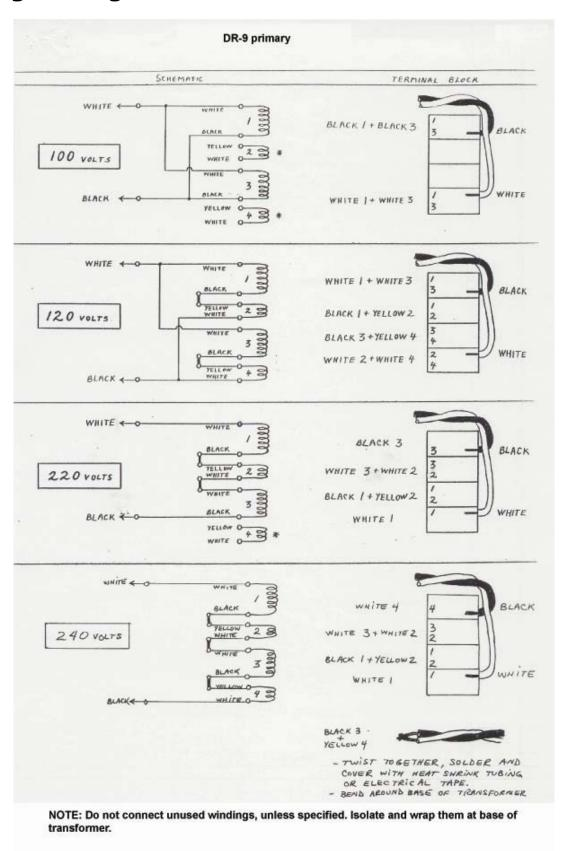
Fig. 1 - 120v AC wiring
