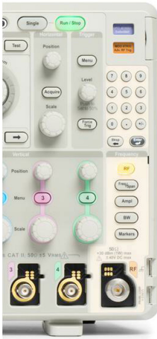
Os principais parâmetros espectrais são ajustados rapidamente com os menus dedicados no painel frontal e o teclado.
