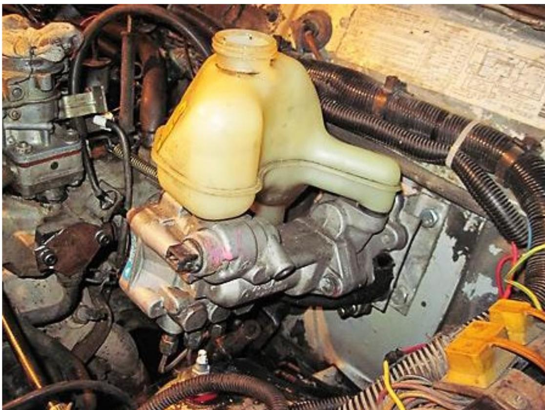
5. Переделка тормозной трубки по длине в связи с креплением тормозной шланги (может понадобиться)
