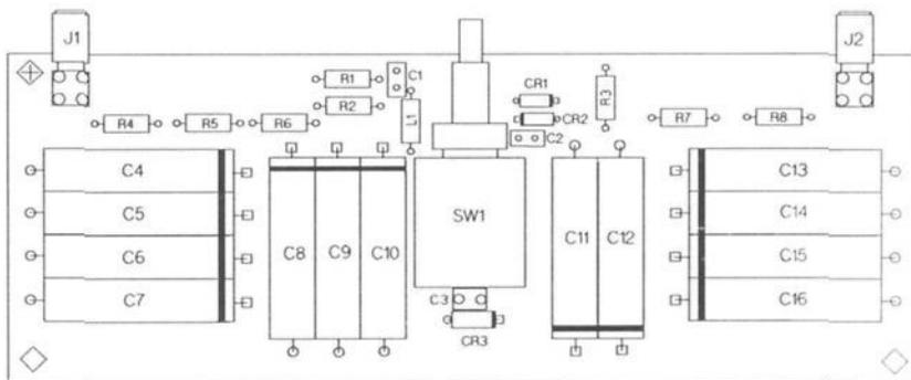
**FIGURE 5-5. A1 COMPONENT LOCATOR**
