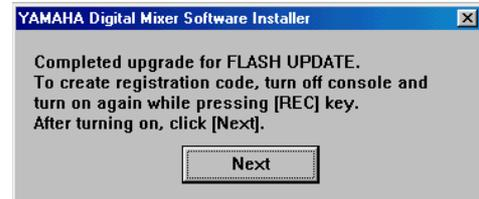
**ACHTUNG:** Bei bestimmten Betriebssystemen erscheint eine andere Meldung (siehe Seite 9). Verlassen Sie das Installationsprogramm gemäß den angezeigten Anweisungen. Schalten Sie das Pult aus, halten Sie den [REC]-Taster gedrückt und schalten Sie es wieder ein. Das Pult zeigt nun die Meldung „FLASH UPDATE“ an. Starten Sie das Installationsprogramm und wiederholen Sie die Schritte 5–9. Fahren Sie fort mit Schritt 14.
