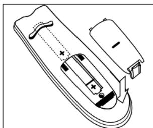
Du trenger to 1.5V batterier, bare type R03, UM4 eller AAA. Sett dem i slik:
