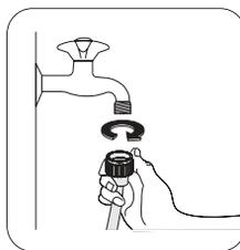
4. Raccordez le tuyau d'arrivée d'eau à un robinet d'eau froide fileté de 3/4". Utilisez toujours le tuyau fourni avec le lave-linge.
