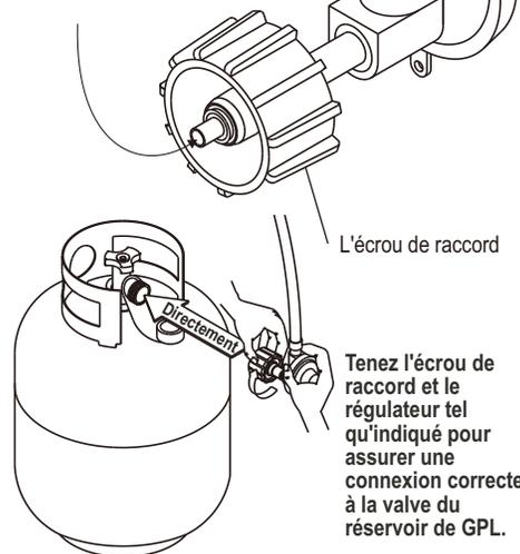
6. Serrez à fond l'écrou de raccord en tournant dans le sens des aiguilles d'une montre. Le régulateur s'attachera de façon étanche au dispositif de non-retour de la valve du réservoir de GPL ce qui occasionnera une certaine résistance. **Une rotation supplémentaire d'un demi à trois quart de tour est nécessaire pour achever le raccordement. Ne serrez qu'à la main - n'utilisez pas d'outils.**
