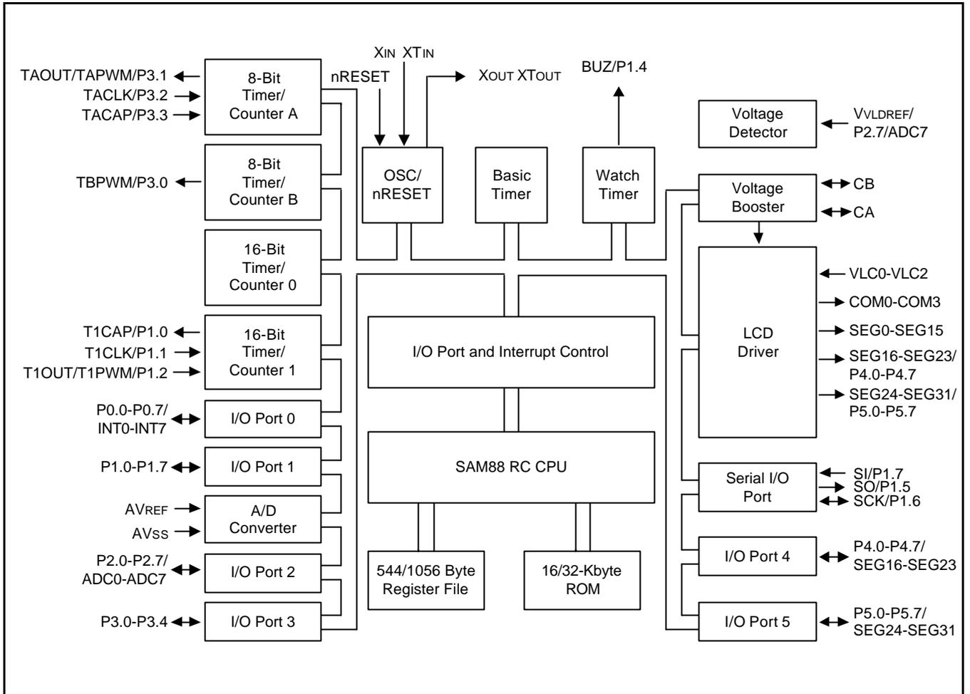
**Figure 1-1. Block Diagram**
