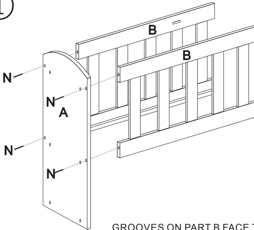
GROOVES ON PART B FACE THE INSIDE AND ARE ON THE BOTTOM.
