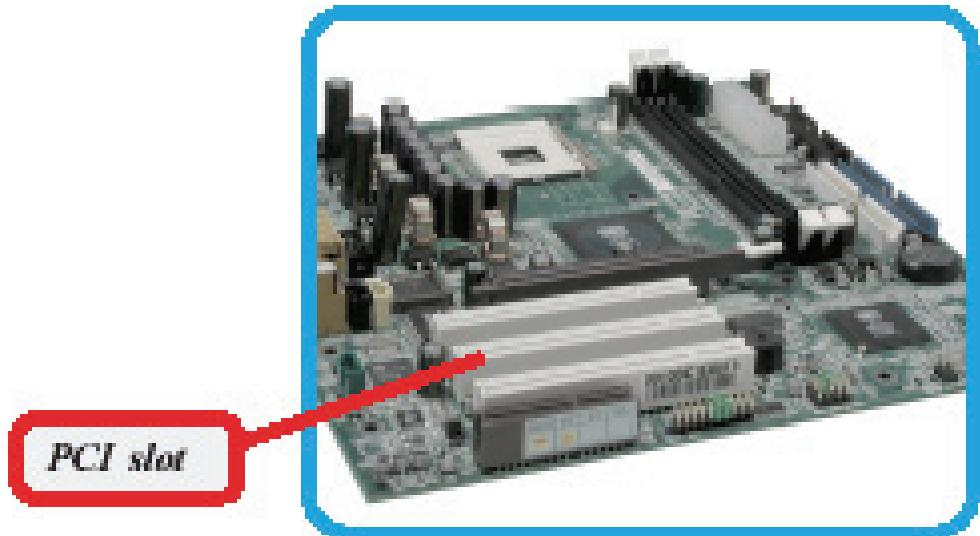
Paso 2. Posicionar el adaptador PCI sobre la ranura y presionar hasta que quede bien fijado.
