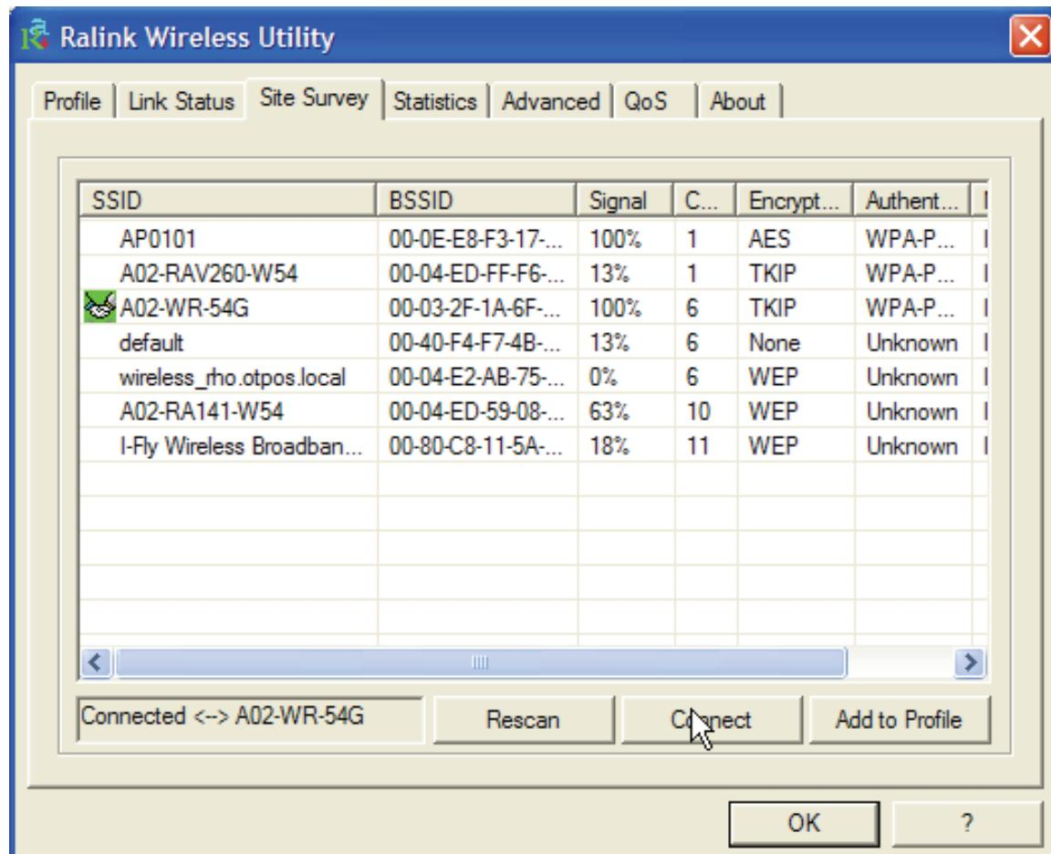
**Rescan (Sondeo):** Inspecciona el entorno para obtener todos los Puntos de Acceso detectados por el cliente.
