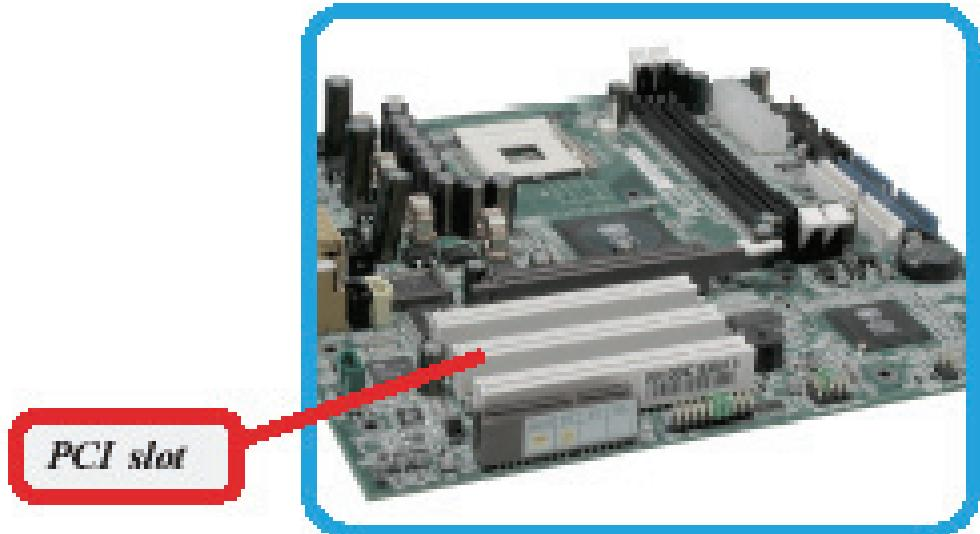
Step 2. Posizionare il Wireless PCI Adapter sullo slot PCI e premere per inserirlo.
