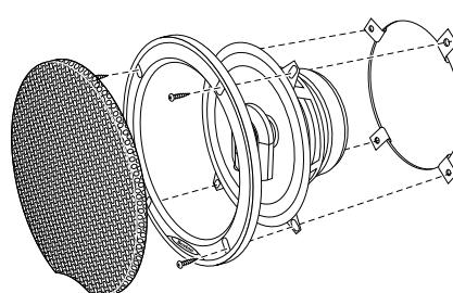
Collegare i fili all'altoparlante e montare il gruppo sulla sfinestratura nel modo illustrato. Accertarsi di collegare il filo positivo con il polo positivo e quello negativo con il polo negativo. Se l'installazione è stata eseguita correttamente, non devono esistere perdite d'aria tra la parte anteriore e quella posteriore della superficie di montaggio dell'altoparlante stesso.
