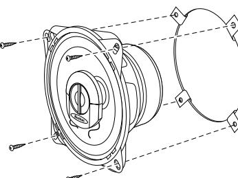
**Instalación:** El FX4 puede ser instalado arriba o debajo de la superficie de montaje detrás de las rejillas montadas en el vehículo. Normalmente se puede instalar el FX4 en su vehículo sin necesidad de recurrir a ninguna modificación. En caso contrario, utilice la plantilla adjunta para recortar un hueco de montaje.
