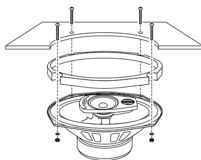
**Instalación:** El FX9<sup>3</sup> puede ser instalado arriba o debajo de la superficie de montaje detrás de las rejillas del vehículo. Normalmente se puede instalar el FX9<sup>3</sup> en su vehículo sin necesidad de recurrir a ninguna modificación. En caso contrario, utilice la plantilla adjunta para recortar un hueco de montaje.
