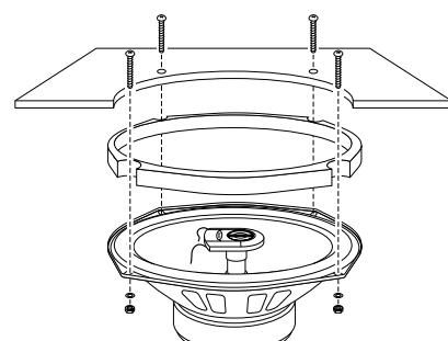
Se l'installazione è stata eseguita correttamente, non devono esistere perdite d'aria tra la parte anteriore e quella posteriore della superficie di montaggio dell'altoparlante stesso.
