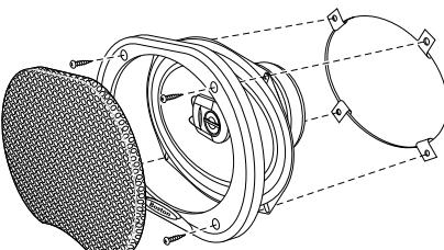
**Installation :** Les haut-parleurs FX9<sup>2</sup> peuvent être installés au-dessus ou au-dessous de la surface de montage, derrière les grilles d'origine. Le système peut généralement être monté sans apporter de modifications au véhicule. Dans le cas contraire, le gabarit fourni permet de découper une ouverture de montage.
