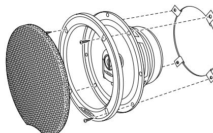
Collegare i fili all'altoparlante e montare il gruppo sulla finestratura nel modo illustrato. Accertarsi di collegare il filo positivo con il polo positivo e quello negativo con il polo negativo. Se l'installazione è stata eseguita correttamente, non devono esistere perdite d'aria tra la parte anteriore e quella posteriore della superficie di montaggio dell'altoparlante stesso.
