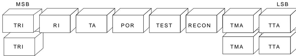
**FIGURE 9 - COMMAND CHAINING STATUS REGISTER QUEUE**
