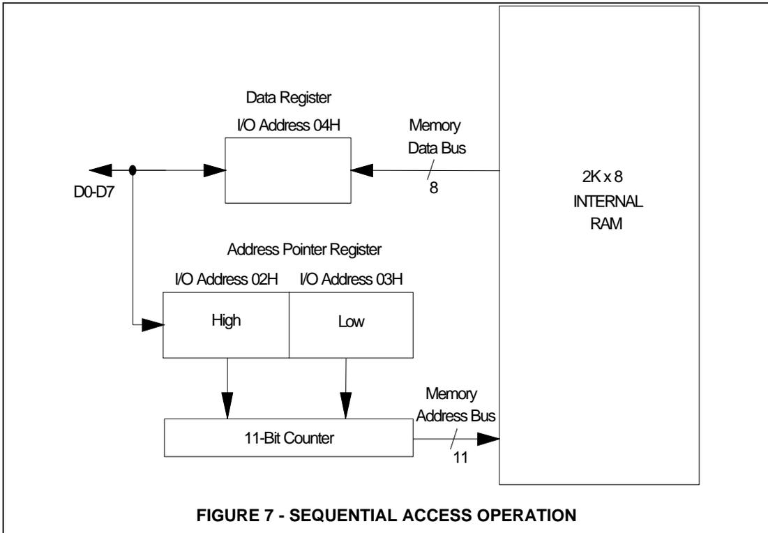
**FIGURE 7 - SEQUENTIAL ACCESS OPERATION**
