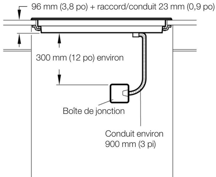
La plaque signalétique comportant les spécifications électriques se trouve sur le dessous de l'appareil. La boîte de jonction doit être placée à 3 pi (91,4 cm) du raccord de connexion de la table de cuisson. On doit pouvoir y accéder facilement aux fins de l'entretien.
