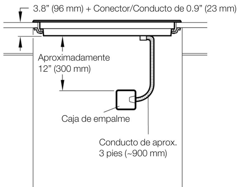
Puede encontrar la placa de identificación con las especificaciones eléctricas en la parte inferior del electrodoméstico. La caja de empalme debe estar ubicada dentro de los 3 pies de la conexión de la placa. Se debe poder acceder a ella fácilmente para realizar las reparaciones.
