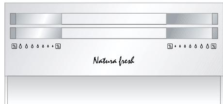
Die Einstellung erfolgt für jede Schublade getrennt durch Betätigung der Schieber in der Schubladenfront.
