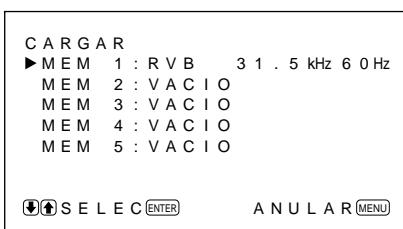
**2** Pulse **↑/↓** para desplazar el cursor (►) hasta MEM 1 a 5 y pulse ENT.
