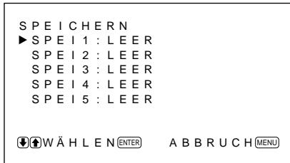
4 Stellen Sie den Cursor (►) mit den Tasten ↑/↓ auf SPEI 1 bis 5, und drücken Sie ENT. Daraufhin wird fünf Sekunden lang "BEENDET" angezeigt. Die aktuellen Einstellungen werden unter der ausgewählten Speichernummer im Gerät gespeichert. Wenn unter der ausgewählten Speichernummer bereits Daten gespeichert sind, werden in der rechten Spalte neben der Speichernummer der Signaltyp und das Farbsystem bzw. die Horizontal-/Vertikalfrequenz angezeigt.
