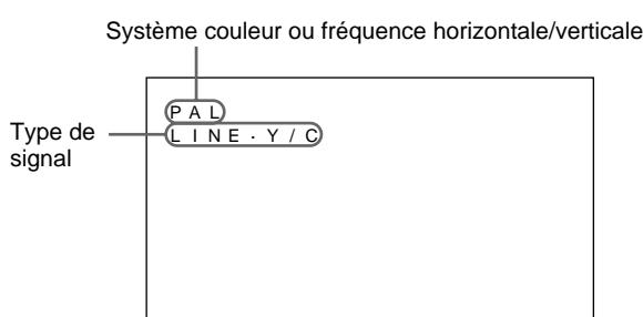
Le signal d'entrée sélectionné apparaît sur l'écran du moniteur.
