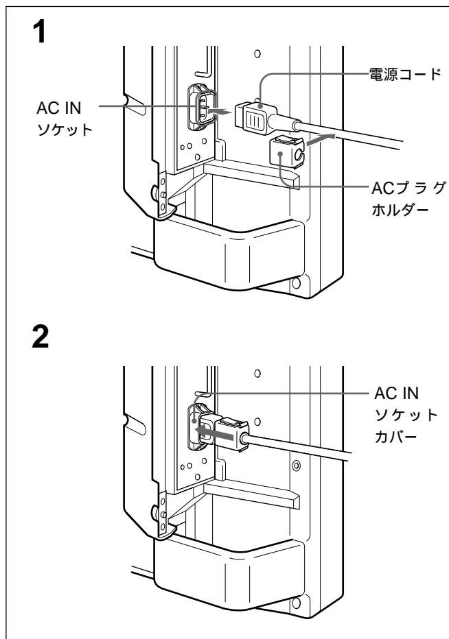
1 電源コードを側面のAC INソケットに差し込み、ACプラグホルダー(付属)を電源コードに取り付ける。
