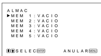
**4** Pulse **↑/↓** para desplazar el cursor (►) hasta MEM 1 a 5 y pulse ENT.
