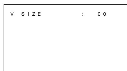
7 ↑/↓ボタンで垂直方向のサイズを調整し、ENTボタンを押す。
