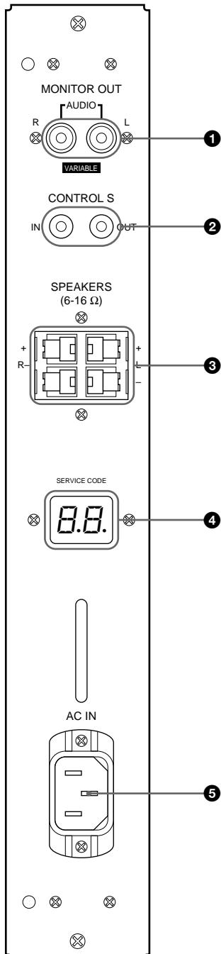
**① MONITOR OUT AUDIO (L/R) (音声出力) 端子 (ビンジャック)**
