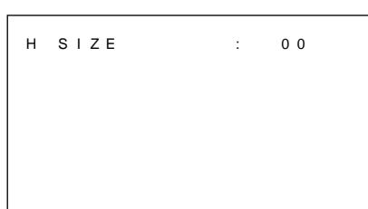
4 ↑/↓ボタンで水平方向のサイズを調整する。
