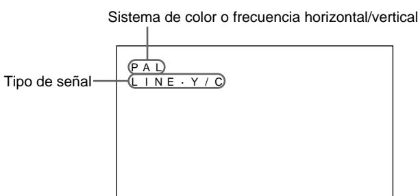
La señal de entrada seleccionada aparece en la pantalla del monitor.
