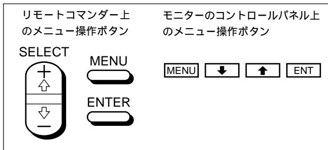
この取扱説明書では、本体のボタンを使って操作の説明をしています。リモートコマンダーのENTERボタンは本体のENTボタンと、SELECT +↑/ -↓ボタンは↑/↓ボタンと同じ働きをします。
