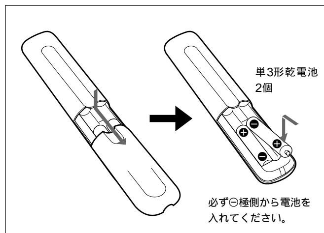
電池の寿命は、通常の使用で約6か月です。リモートコマンダー操作が効かなくなり始めたら寿命ですので、新しい電池とお取り換えてください。
