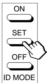
È possibile far funzionare solo un monitor specificato. (Nel modo ID sono possibili tutte le operazioni eccetto quelle di POWER ON/OFF.)
