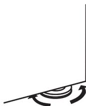
4. Utiliser un niveau pour revérifier que la machine à glaçons est bien d'aplomb d'avant en arrière et transversalement. Dans le cas contraire, répéter les étapes 2 et 3. Si la machine est d'aplomb, passer à la section "Raccordement à l'alimentation en eau".
