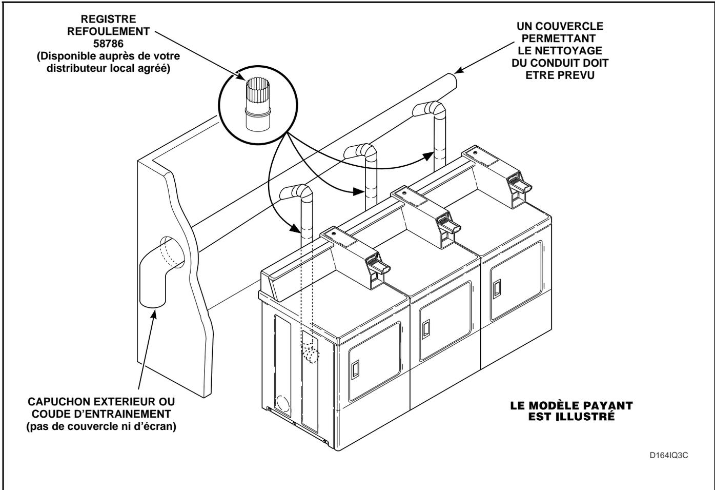
**IMPORTANT :** La pression statique dans le conduit d'évacuation de chaque sècheuse ne doit pas être supérieure à celle indiquée sur le tableau en page 63. Cette pression peut être mesurée par un manomètre placé dans le conduit d'évacuation à environ deux pieds (60,96 cm) de la sècheuse, voir page 63. Toutes les sècheuses raccordées au conduit collecteur principal doivent être en usage lorsque la pression est mesurée.
