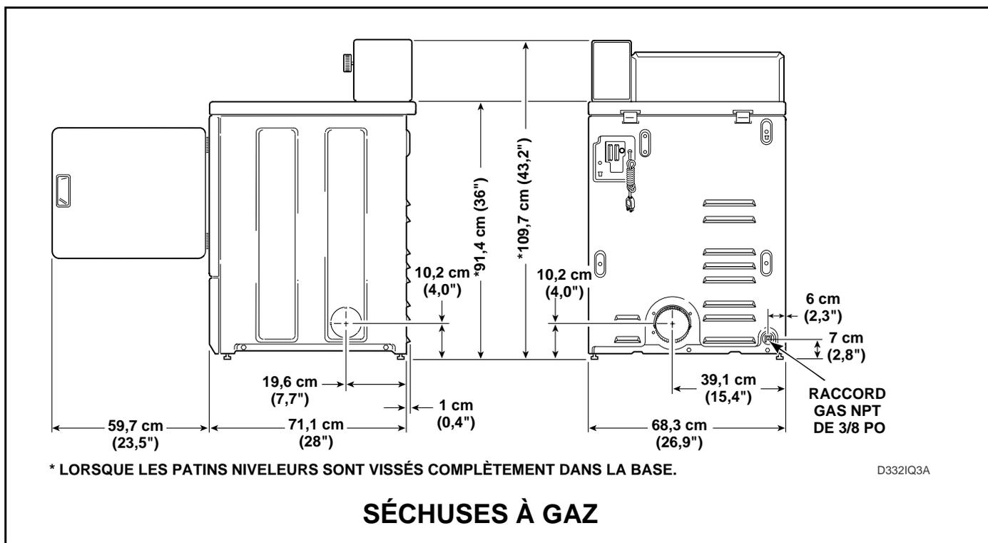
**REMARQUE :** Les ouvertures d'échappement sur les côtés, l'arrière et le dessous sont prévus pour conduits de 10,2 cm (quatre pouces). Les sècheuses à gaz ne peuvent avoir d'échappement sur le côté gauche de la caisse en raison du logement du bec de gaz.
