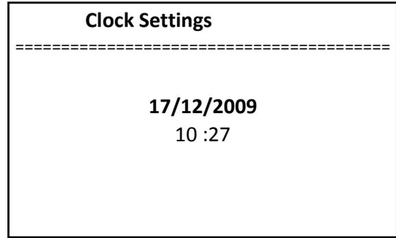
Once entered in the menu « Clock setting », the software requires in turn the year (Year), the month (Month), the day (Day), the time (hour) and the minute (Min). Once in the menu, the « + » and the « ++ » allows to increase the value, the « - » and the « - - » allows to decrease the value. The « ++ » and « - - » allow a rapid scroll of the values, the « + » and « - » allows a slow scroll of values.
