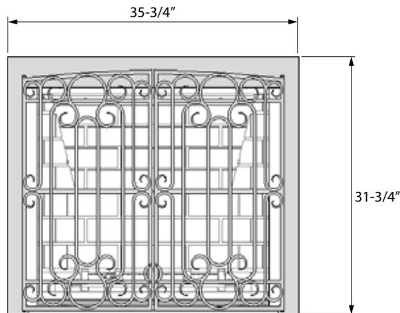
**NOTE** : Le bas de la plaque est égal au bas du foyer. Le bas du foyer **DOIT** être au même niveau ou supérieur à la surface du plancher fini devant le foyer.
