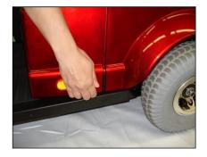
Entfernen Sie den Akkudeckel, indem Sie das elastische Band an der Vorderseite des Deckels und den Klettverschluss an beiden Seiten des Akkudeckels lösen.
