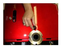
Lösen Sie den hinteren Deckel vom Hinterrahmen, indem Sie den Drehknopf gegen den Uhrzeigersinn drehen und den Klettverschluss an beiden Seiten des Deckels lösen.
