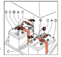
Die neuen Akkus werden wie folgt in umgekehrter Reihenfolge eingesetzt:
