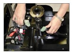
Lösen Sie das Hauptkabel, bevor Sie die Rahmenteile des Scooters auseinander nehmen.
