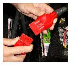
Lösen Sie die roten und schwarzen Akkukabel.
