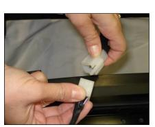
Kippen Sie den hinteren Deckel vorsichtig zur Rückseite des Scooters, so dass das Innere zum Vorschein kommt. Suchen Sie den Verbindungsstecker der Rücklichter und ziehen Sie ihn ab. Jetzt können Sie den hinteren Deckel vollständig abnehmen.
