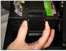
Lösen Sie das Band, das die Akkus sichert.
