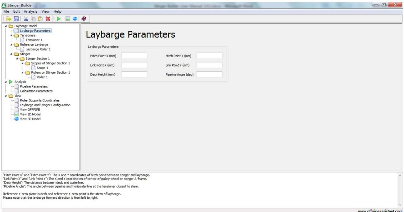
Fig. 3.3 Input laybarga parameters
