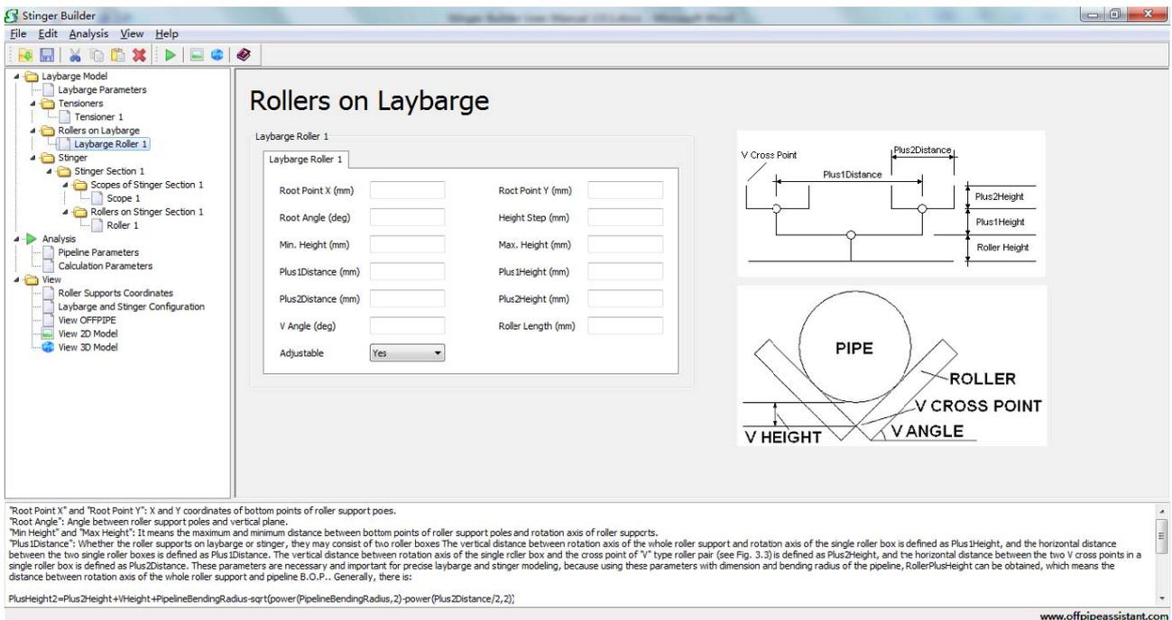
Fig. 3.7 Input parameters for each laybarge roller
