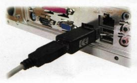
请参照上图把 USB 记录器连接在电脑主机和 USB 键盘, USB 记录器将开始记录所有输入的按 键.
