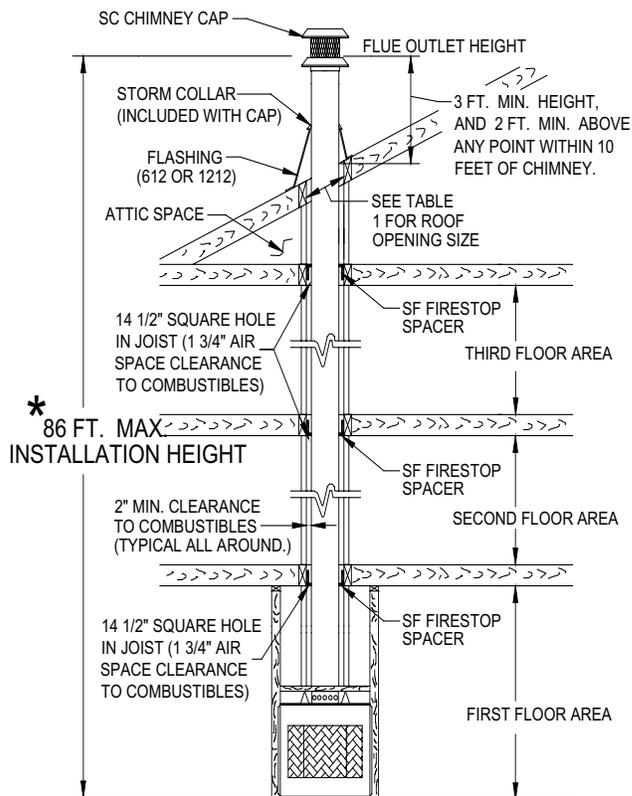
\*: SCS CHIMNEY SUPPORT REQUIRED EVERY 30 FEET OF INSTALLATION HEIGHT.
