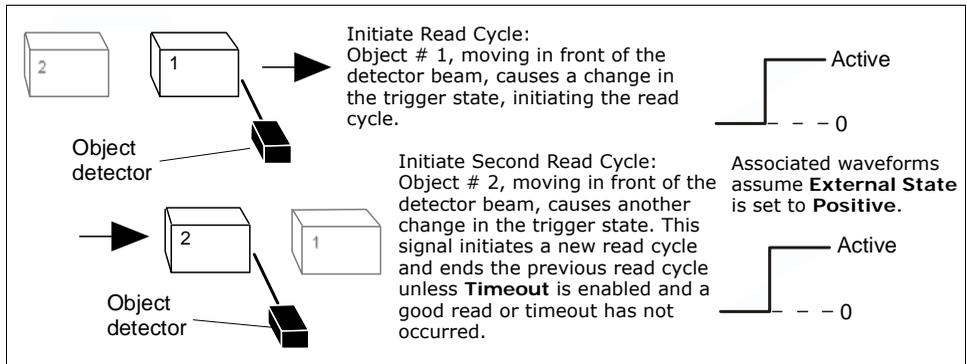
Figure 4-3 Trigger Edge
