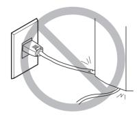
Ne jamais déposer aucun objet sur le câble, sur la fiche ou sur la prise car cela risque de les endommager.
