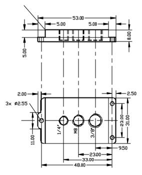
All threads min. 6mm depth All radii 2mm
