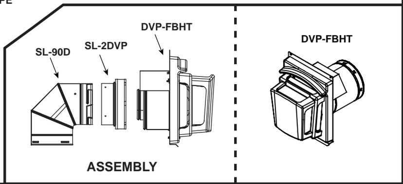
Figure 16.9 SL D-Series Vent Components
