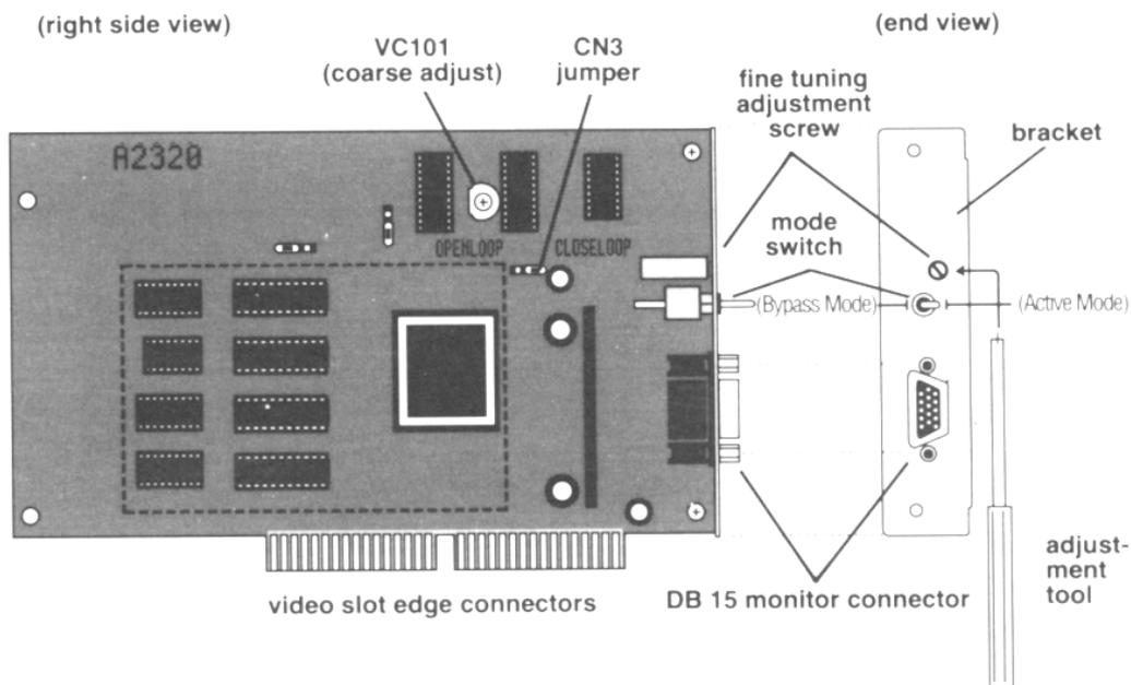
**Fig. 4: A2320 Display Enhacer Board**
