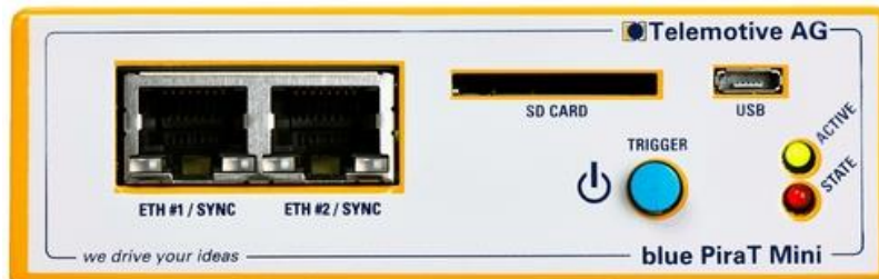
Figure 7.1: blue PiraT Mini front panel
