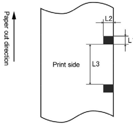
L1 mark height:  $3\text{mm} \leq L1 \leq 13\text{mm}$
