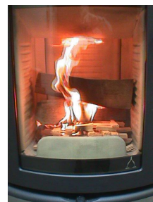
III. 4 : Chiusura presa d'aria primaria
