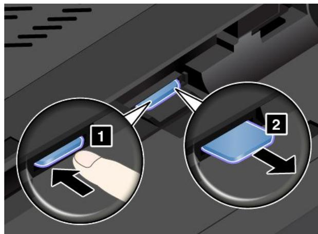
5. Halten Sie die neue SIM-Karte so, dass der Metallkontakt nach oben zeigt und zuerst in den Steckplatz geschoben wird. Setzen Sie die SIM-Karte dann fest in diese Öffnung, bis sie hörbar einrastet.
