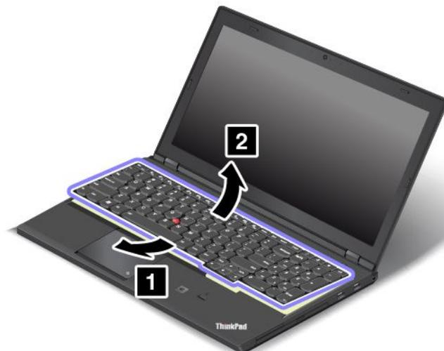
8. Legen Sie die Tastatur vorsichtig auf die Handablage und ziehen Sie die Stecker ab. Anschließend entfernen Sie die Tastatur.
