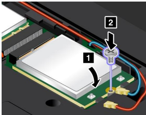
10. Schließen Sie die Antennenkabel an die Karte für drahtlose WAN-Verbindungen an. Stellen Sie sicher, dass das rote Kabel am Hauptanschluss der Karte und das blaue Kabel am AUX-Anschluss der Karte für drahtlose WAN-Verbindungen angeschlossen ist.
