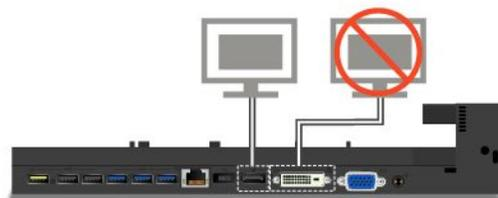
Wenn Sie beim ThinkPad Ultra Dock zwei Bildschirme an den DisplayPort- und den DVI-Anschluss anschließen, wird der DVI-Anschluss deaktiviert.
