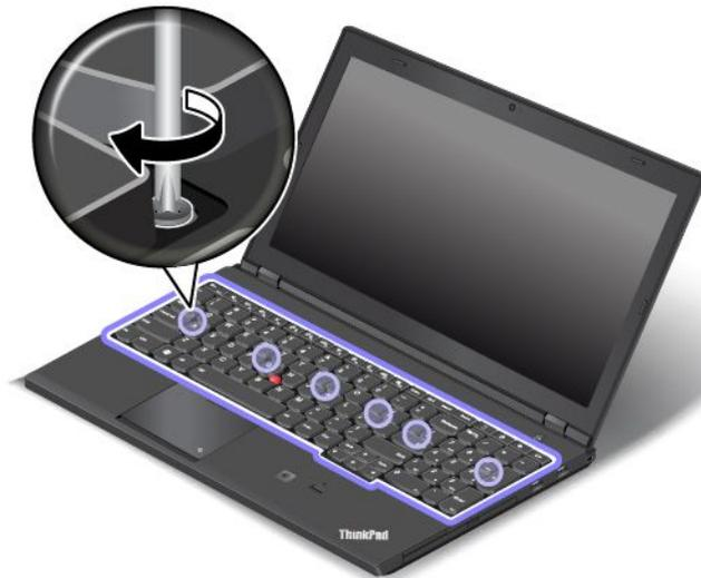
5. Schieben Sie den Tastaturrahmen mithilfe des flachen Endes des Tastatur-Multifunktionswerkzeugs um 2,5 mm nach hinten. Verbergen Sie die Verriegelungen des Tastaturrahmens unter der Tastaturblende, indem Sie die Verriegelungen wie angezeigt mit Ihren Fingern drücken.
