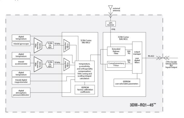
Figure 15 - 3DM-RQ1-45<sup>™</sup> Block Diagram
